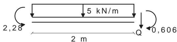
d) Drehwinkel bei Erhöhung der Drehfedersteifigkeit und Biegesteifigkeit
