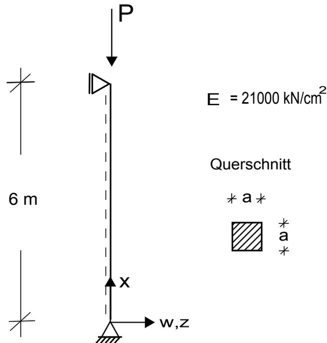
Die zur **dritten** Eigenform korrespondierende Knicklast  $P_{ki,3}$  des Systems wurde bereits berechnet und beträgt  $P_{ki,3} = 8000 \text{ kN}$ .
