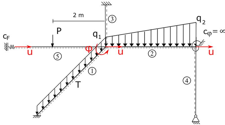
(Anteile der Stäbe farblich: **Stab 1**, **Stab 2**, **Stab 3**, **Stab 4**. Achtung: Stab 5 liefert keine Steifigkeit, da freies Ende.)
