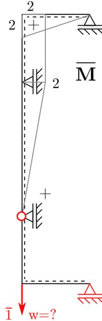
vertikale Verschiebung an Knoten 2 und 3 sind identisch:
