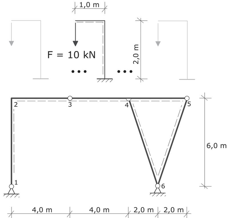
Auf dem dargestellten Hallendach soll für Bauarbeiten ein kleiner Kran errichtet werden. Ermitteln Sie im Hinblick auf die folgenden Maßgaben die günstigste Kranposition auf dem Lastgurt 2-3-4-5. Beachten Sie dabei, dass die Stellung der Last  $F$  innerhalb der Knoten 2-5 bleiben muss.
